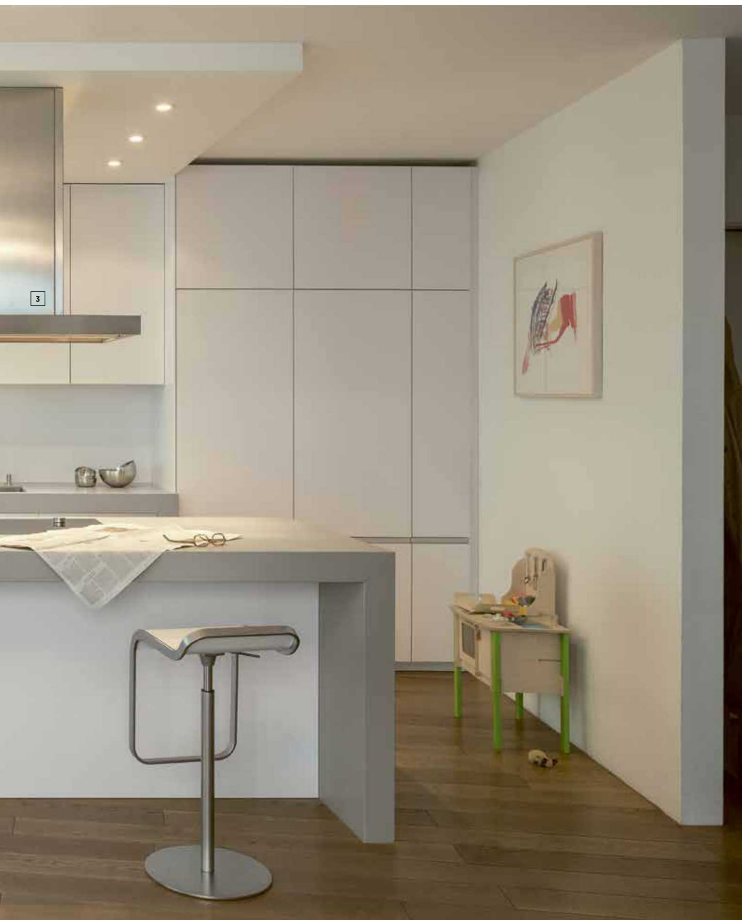
3 Die Abzugshaube ist größer als die Kochfläche, um die Abzugsleistung zu erhöhen.
