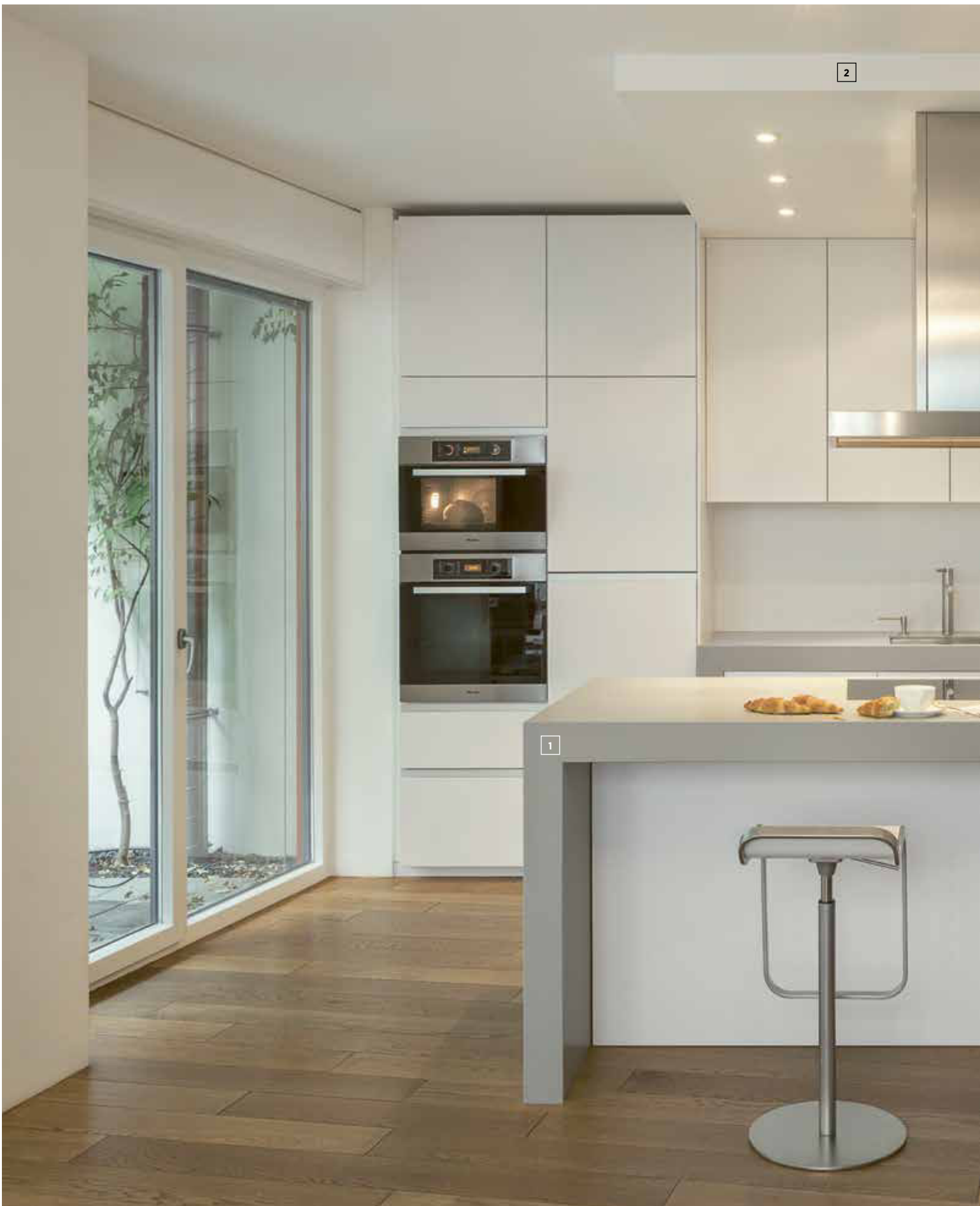
1 Der massiv ausgestaltete Arbeitstisch der Insel setzt einen visuellen Schwerpunkt vor der Leichtigkeit der Rückwand und nimmt das Design des Spültisches auf. 2 Die partiell abgehängte Decke bietet Platz für eingebaute Lichtspots sowie den Flachkanal der Abluft.
